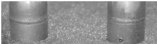
图6 铅环焊缝腐蚀试验结果
